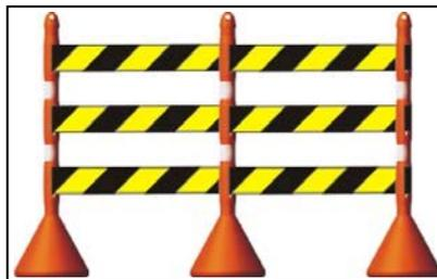
Los señalizadores deben contar con por lo menos dos cintas retroreflectivas blancas de 3 pulgadas de ancho, de especificación mínima de grado ingeniería y deben contar con un lastre que proporcione estabilidad para que permanezcan en posición durante la
